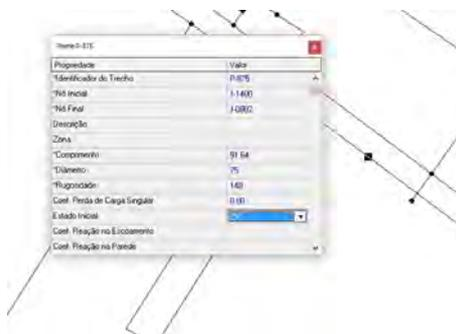
Para Válvula de retenção o que vai para o Epanet é o Estado
